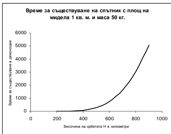
Фиг. 3. Средна продължителност на съществуването на спътник с маса m=50\text{кг} и площ на мидела F_m=1\text{м}^2 .
