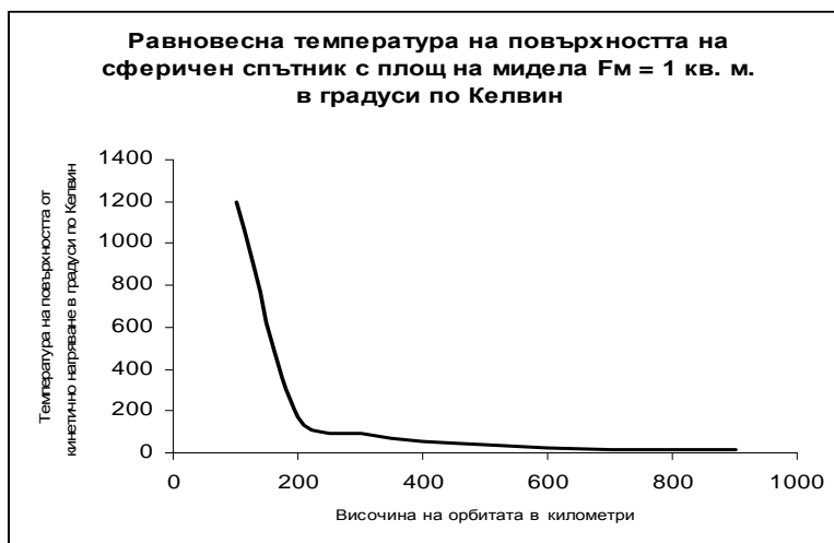
Фиг. 5. Зависимост на равновесната температура T(^{\circ}\text{K})=f(H, \text{ км}) на повърхността на сферичен спътник с площ на мидела F_M = 1 \text{ м}^2
